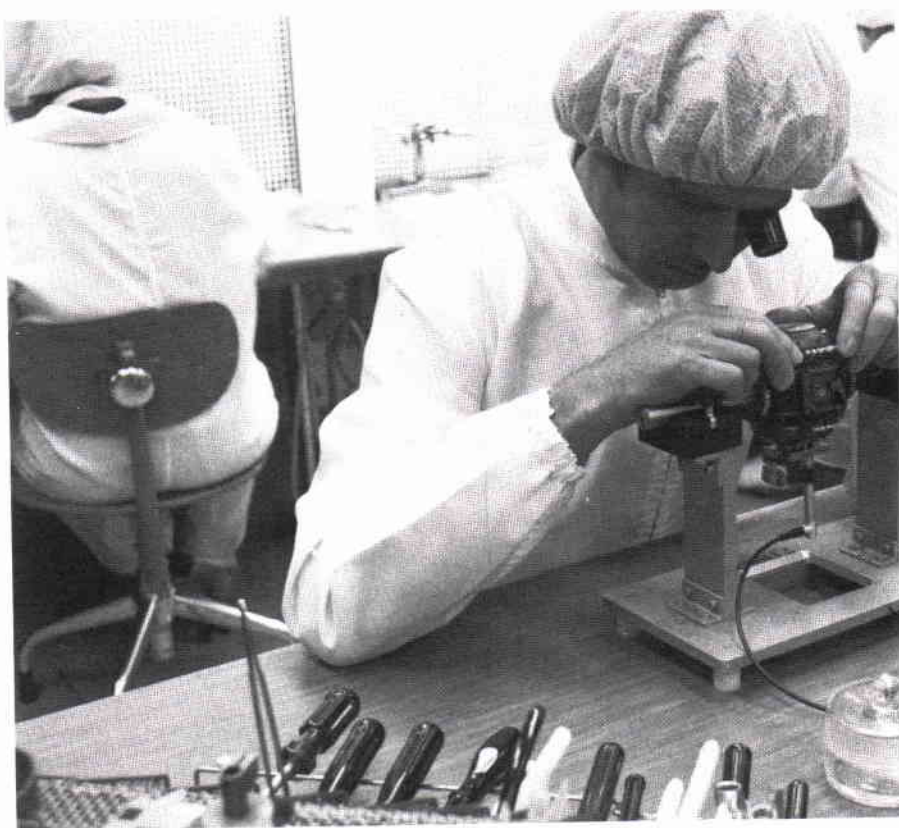
Glappsättning av gyrokardan – toleransvidd 0,15 µm
